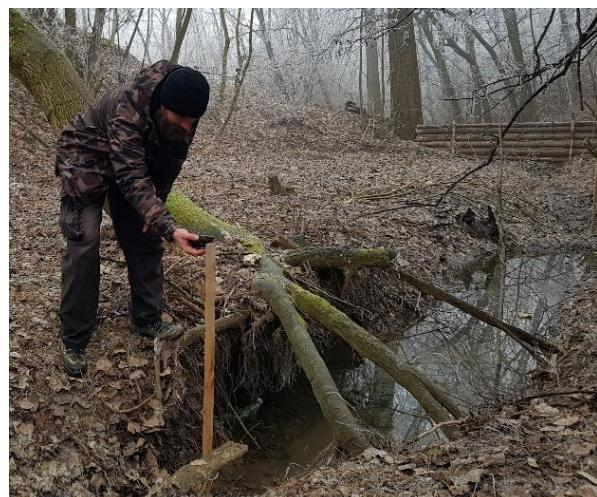
Figura 42 - Proiectarea unui sistem simplu de măsurare pentru a monitoriza colmatarea rezervorului din spatele barajelor din bușteni, situate în șanțurile de eroziune, folosite ca și capcane de sedimente. (Fotografie: WWF HU)
