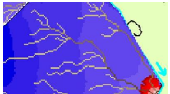
A lézeres távérzékeléssel (LIDAR) felmért területeken térinformatikai eszközökkel azonosították a felszíni vízfolyások összefolyási pontjait, azokat az ideális helyeket, ahol a leghatékonyabban lehet tározót létesíteni.
